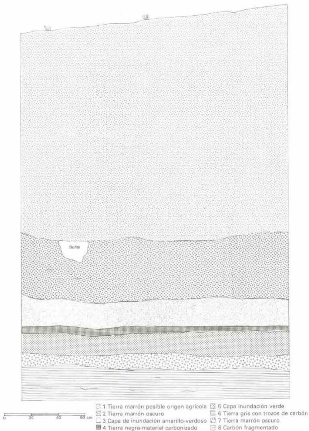
Figura 7. Diseño de un perfil desde el sitio PK-1 a , Test Pit 1: Pared Oeste. El perfil ilustra dos capas sustanciales inundadas dentro la estrata. El amarillo-verde, capa inundada, puede referirse a un episodio de localización inundada causada por dislocaciones del río, mientras la capa verde aparentemente se relaciona a más inundaciones generalizadas causadas por la elevación del nivel del lago.
